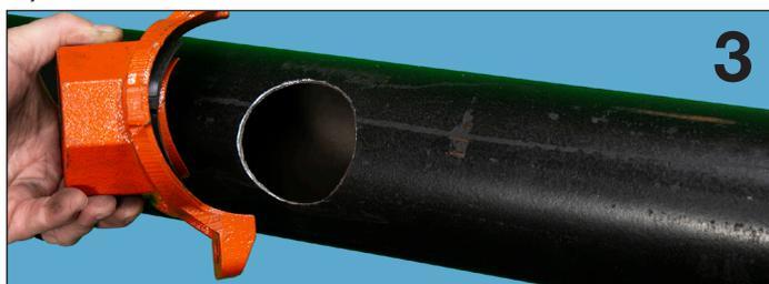
**3.** La junta tiene lubricante incrustado en la goma y un lubricante en polvo seco aplicado en la superficie durante el montaje en la fábrica. No se requiere lubricante adicional. Asegúrese de que la junta esté correctamente instalada en la carcasa de salida de la Tee mecánica y luego alinee la carcasa con el orificio cortado en la tubería, asegurándose de que la ubicación de la T mecánica encaje en el orificio cortado de la tubería.
