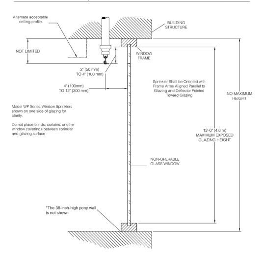
FIGURE 6—PENDANT VERTICAL SIDEWALL SPRINKLER INSTALLATION
