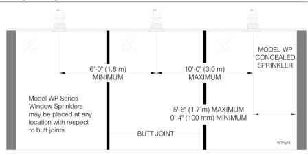
FIGURE 5— CONCEALED PENDANT VERTICAL SIDEWALL SPRINKLER SPACING
