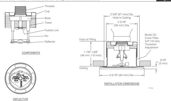
FIGURE 3—CONCEALED PENDANT VERTICAL SIDEWALL SPRINKLER
