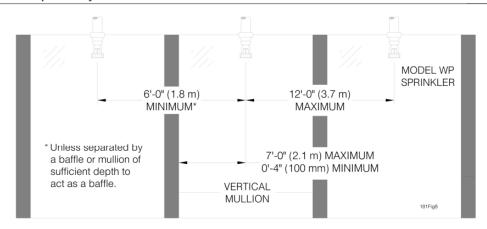
FIGURE 4—PENDANT VERTICAL SIDEWALL SPRINKLER SPACING
