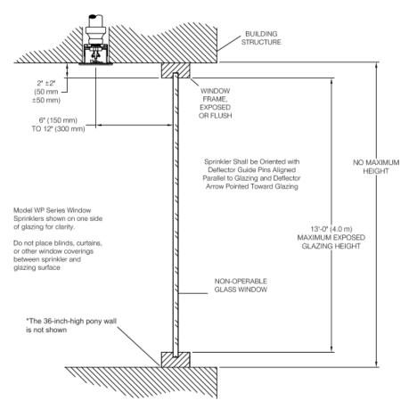
FIGURE 7—CONCEALED PENDANT VERTICAL SIDEWALL SPRINKLER INSTALLATION
