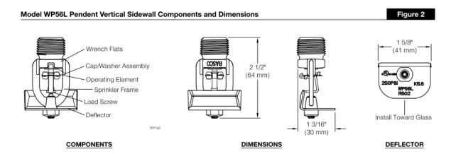
FIGURE 2—PENDANT VERTICAL SIDEWALL SPRINKLER
